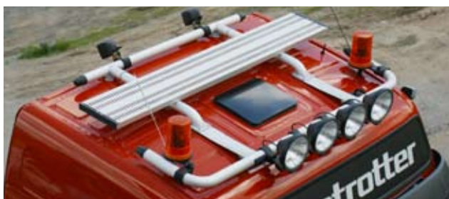
Montage de toit Trux sur L2H2 (G14-3, E14-3, G14-1 et Passerelle 15935)
