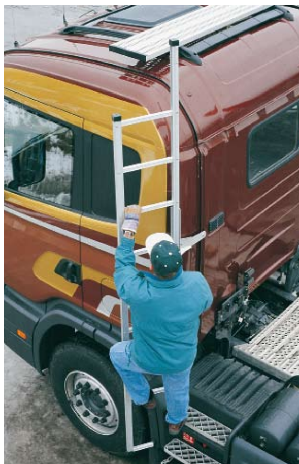
Échelle de cabine Trux pour Scania (M22-251L et M22-251R)
