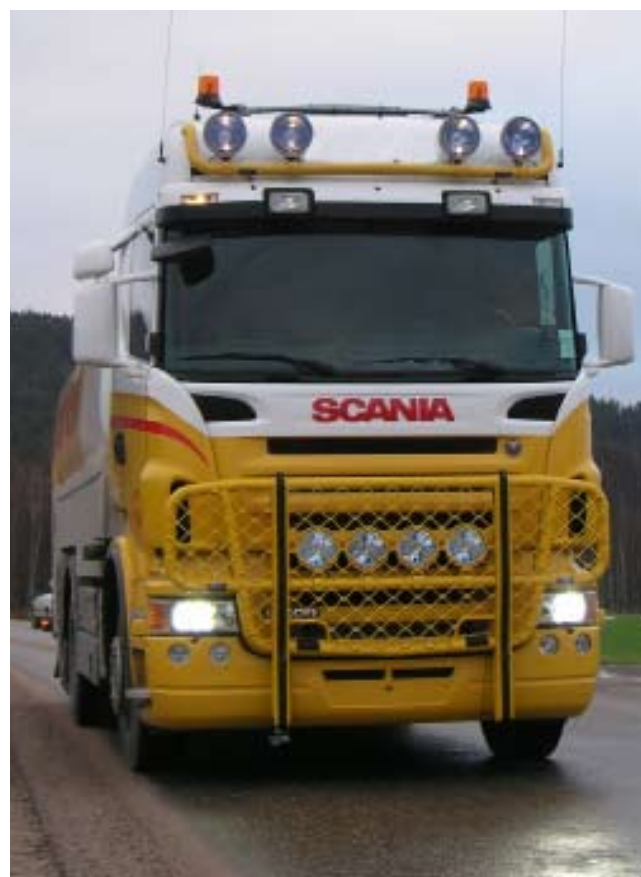
Trux Top-Bar et Offroad faible modèle pour Scania CR19H (G23-6 et B23-3)
