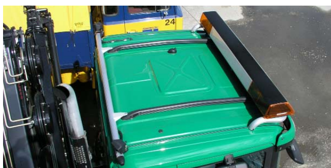
Montage de toit Trux pour Scania CP16L (G23-1 et G23-5)
